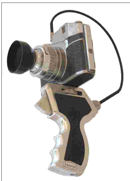
Fig 32 – apparecchio con impugnatura a pistola
