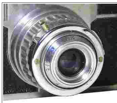
Fig 19 - particolare obiettivo con scala messa a fuoco incisa e ghiera conica
