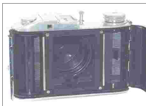
Fig 7 – Koroll S aperta con riduttori inseriti predisposta per il formato 6x4,5 cm
