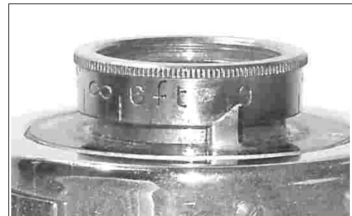
Fig 23 – particolare di obiettivo con scala in piedi
