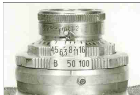
Fig 2 – Comet 35: particolare obiettivo con ghiera per tempi e diaframmi
