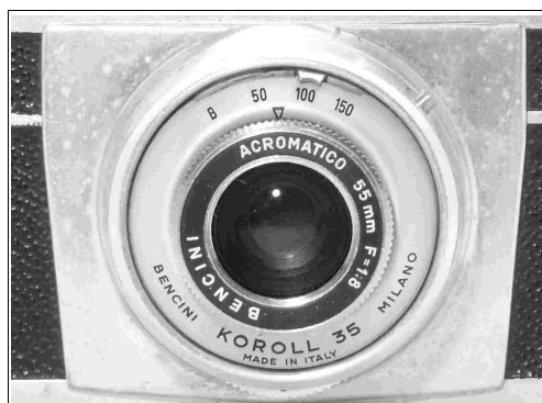
Fig 9 – Koroll 35 (2° modello): particolare obiettivo e selettore tempi otturatore
