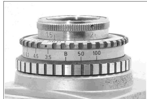
Fig 3 – Korolette: particolare selettore tempi
