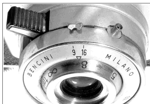
Fig 2 – Cometa: particolare obiettivo con selettore diaframmi, leva di scatto e spinotto sincro flash
