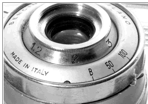
Fig 4 – Cometa: particolare obiettivo con selettore tempi di otturazione
