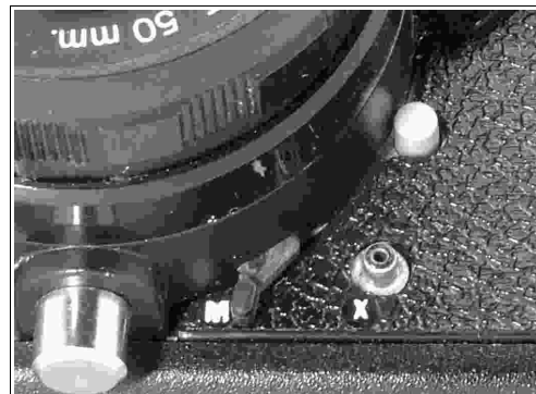
Fig 19 – NK 135 Electronic: particolare pulsante accensione esposimetro
