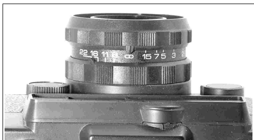
Fig 29 – Comet 235: particolare obiettivo con indicazione dei diaframmi con valori numerici
