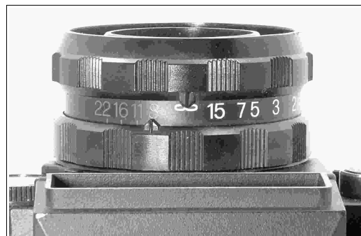
Fig 9 – K 35: particolare obiettivo con scala in metri e scala diaframmi
