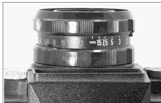
Fig 3 – NK 135: particolare obiettivo con scala in metri e scala dei diaframmi
